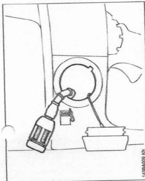
Substituir o cabeçote de aspiração anualmente, para isso:
